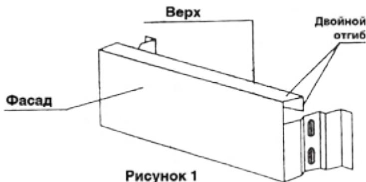
**Крышка шкафа.** На внутренней поверхности крышки с трех сторон расположаются 4 детали с восемью продолговатыми отверстиями для крепления к боковым и задним стенкам (рис. 2).
